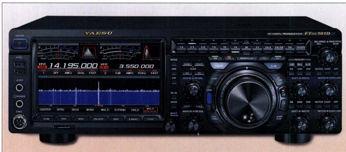
Bild 1: Frontansicht des FTdx101D; bestimmende Elemente sind das Display, hier mit herkömmlichem Spektrumskop und Wasserfall, sowie der Abstimmknopf mit dem dahinterliegenden Mehrzweck-Wahlring MPVD und den drumherum angeordneten, für den laufenden Funkbetrieb wichtigsten, griffgünstig angeordneten Bedienelementen.
