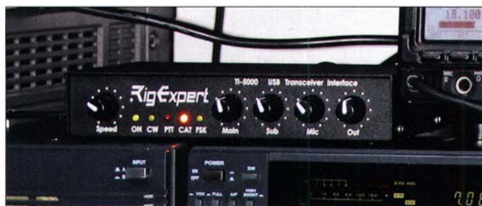
Ansicht des TI-5000, v. l. n. r.: Stellknöpfe für CW-Geschwindigkeit (Winkey), Pegel des Haupt- und Sub-RX sowie des Mikrofoneingangs- und TX-NF-Ausgangssignals
