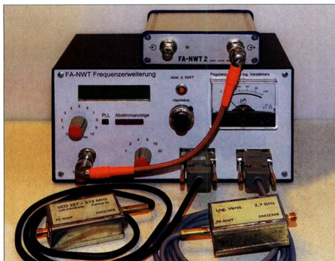
Bild 1: FA-NWT 2 mit angeschlossener NWT 1-Frequenerweiterung; im Vordergrund links ist der Oszillatorbaustein für das 70-cm-Band zu sehen, rechts befindet sich der Detektortastkopf, der bis 2,7 GHz einsetzbar ist. Das Koaxialkabel mit dem orangefarbenen Knickschutz verbindet den Ausgang des FA-NWT 2 mit dem Steuereingang der Frequenerweiterung.
