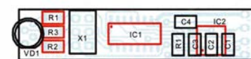
Bild 13: Bestückungsplan der Platine der Slave-Baugruppe; die rot markierten Bauteile sitzen auf der Unterseite; Abmessungen 45,1 mm x 9,5 mm; M 1:1
