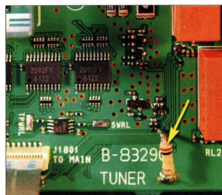
Der zusätzlich eingebaute Widerstand bewirkt eine Erweiterung des Abstimmbereichs des Antennentuners Foto: DK7ZB
