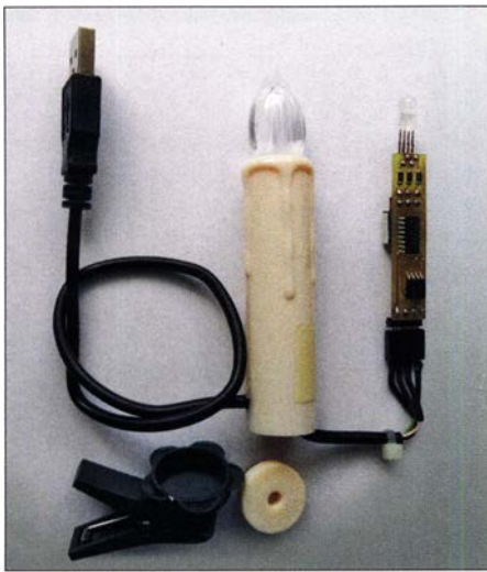
Bild 9: Die Leiterplatte der Slave-Baugruppe lässt sich in die Hülle einer geleeerten Kerze einschieben.
