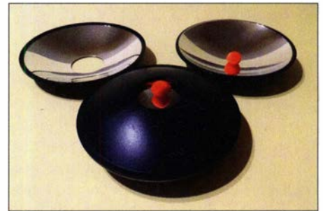
Bild 6: Beim 3-D-Miraskop ist oberhalb des Lochs im Parabolspiegel seitlich schräg ein virtuelles 3-D-Bild des auf dem unteren Parabolspiegel liegenden Objekts zu sehen.
