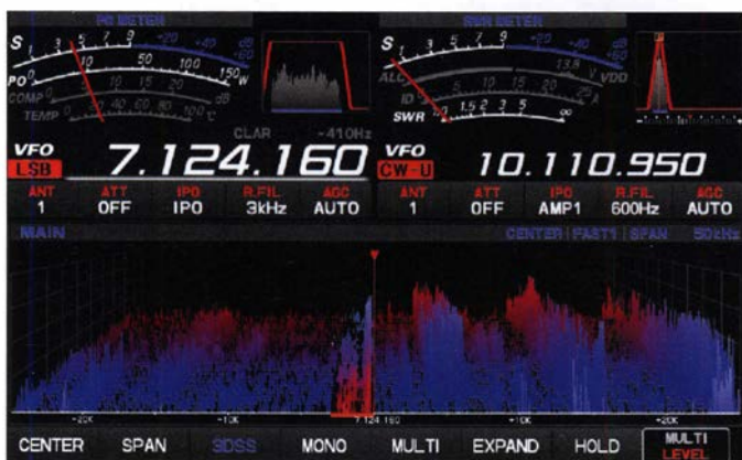
Bild 5: So ähnlich sieht die 3DSS-Darstellung in der Grundeinstellung aus. Den größten Teil nimmt der Direktabtast-SDR ein. Das DSP-Schmalband-SDR ist der schmale anders gefärbte Bereich in der Mitte.
