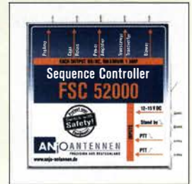
Sequenzer FSC52000 im Weißblechgehäuse; die Lötanschlüsse dienen zur Verbindung mit der Peripherie.
