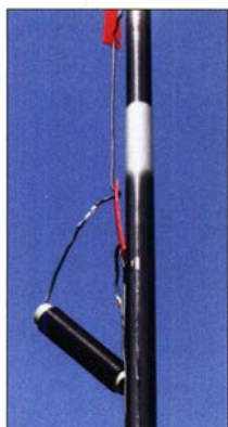
Bild 8: 40-m-Spule zwischen dem 10-m- und 12-m-Abschnitt am senkrechten Antennenträger
